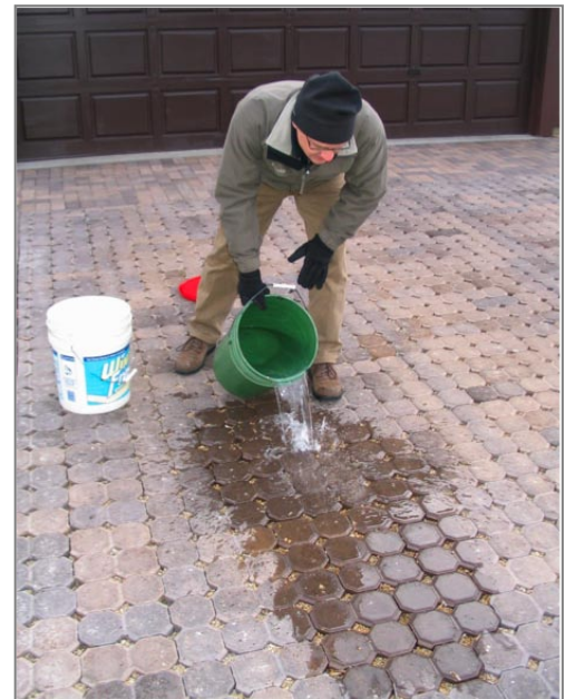
Pavé préfabriqué perméable démonstration University of Minnesota (2007)
