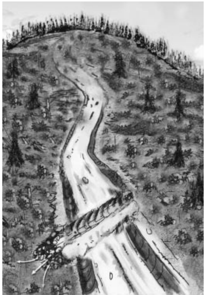
Figure 3.2 - Digue de déviation
