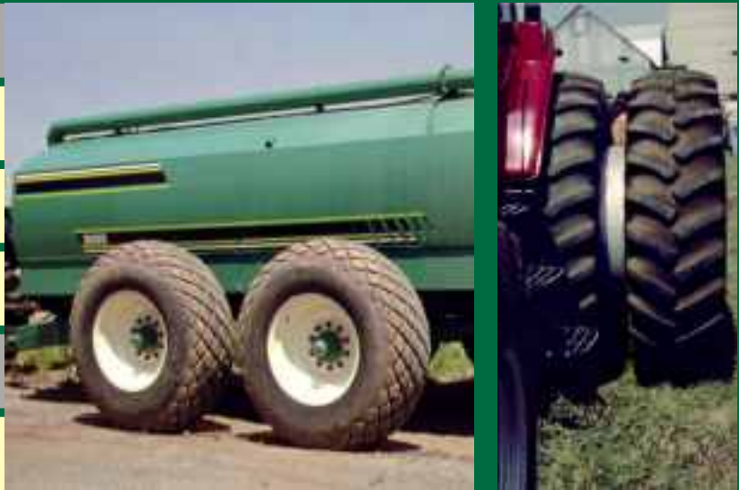
Pneus réduisant la pression au sol et roues jumelées
